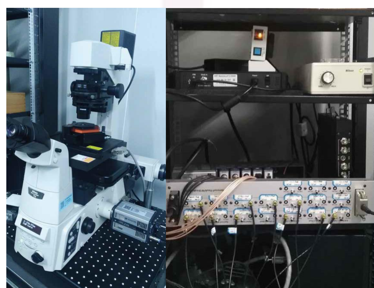
图4 AFM/光学显微镜共焦操作系统
